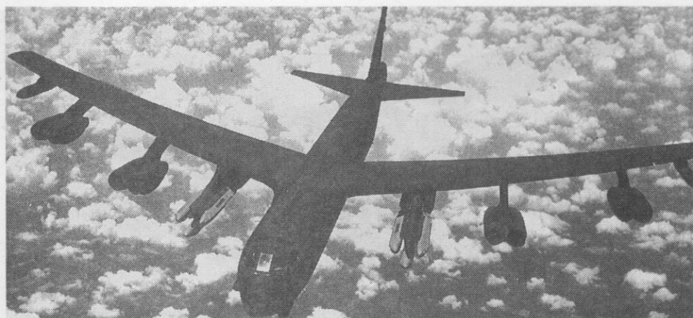
Рис. 2. Стратегический бомбардировщик B-52G ВВС США с крылатыми ракетами AGM-86B ALCM на внешней подвеске
